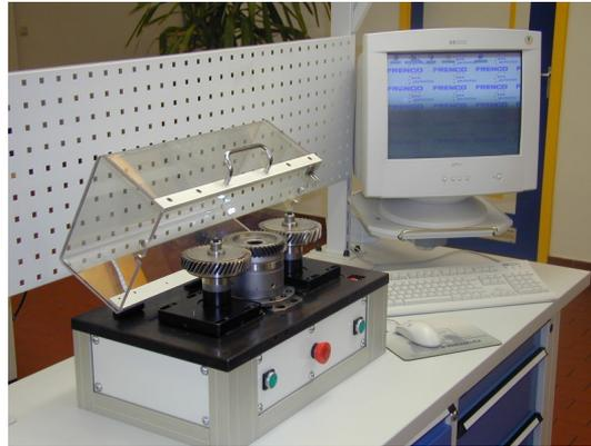
Stazione di misura completa – versione senza supporto con bloccaggio automatico
