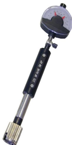
IVMF 1x1 strumento per controllo interni, per piccolo millerighe, con impugnatura e comparatore
