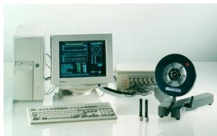
Stazione di misura di dentature esterne. AVMF 3x2 RS con computer, adattatore e convertitore Tetra box
